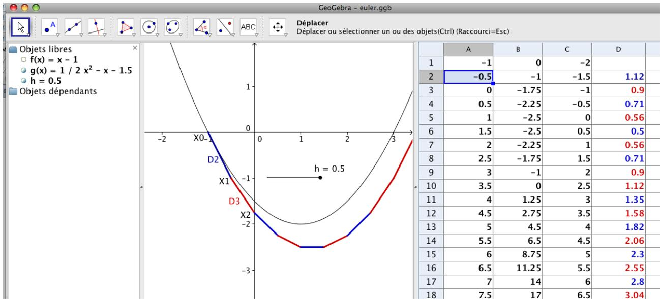
On cherche à construire la courbe représentative de la primitive  $F$  de la fonction  $f(x) = x - 1$  passant par le point  $X_0(-1; 0)$ .
